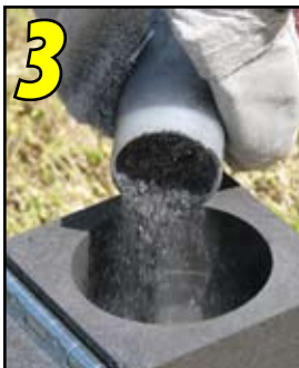
Pour powder into crucible
